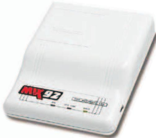
**Mix92** è un dispositivo che riconosce automaticamente le chiamate fax-modem-telefono su 2 linee analogiche.
